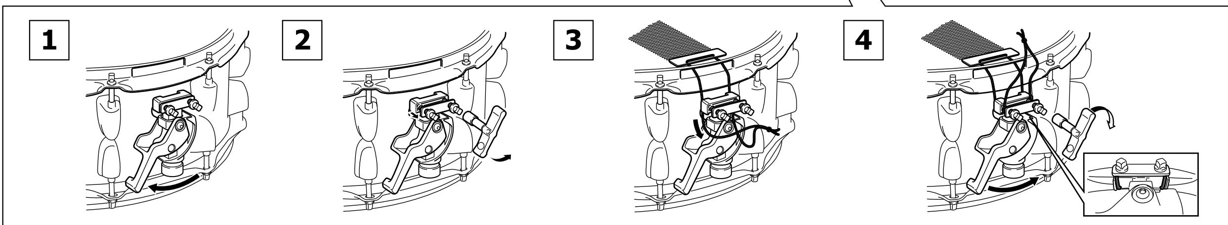
■ストレイナー Q/DC3 へのスネアテープ取付方法 ■How to attach the snare tape to the Q/DC3 strainer
